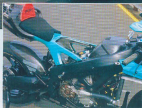
La selle autoprotectrice en fibre de carbone sert également de support aux silencieux d'échappement. Toujours pour un gain de place, le renfort du bras oscillant est situé en dessous de celui-ci, dégageant ainsi plus de place pour l'amortisseur arrière.
