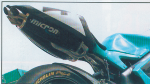
Positionné vers l'arrière, le moteur offre une place importante et un grand volume à la boîte à air.
