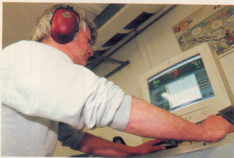
Grâce au logiciel «tuning link», chaque point de la cartographie (graphique régime moteur et ouverture du papillon des gaz) peut être précisément ajusté. Ici, Marc s'attache à améliorer la réponse de la RSV 1000 R aux mi-régimes...
