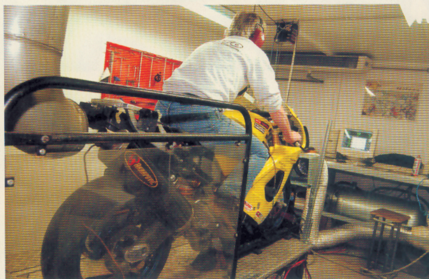
La RSV 1000 R du team «Hexagone Endurance» dispose d'une boîte à air ouverte, c'est-à-dire que le couvercle supérieur est supprimé. L'étanchéité est assurée par le fond du réservoir, via un joint spécial d'origine Aprilia Racing.
